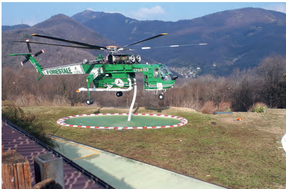
L'Erickson S-64F si rifornisce d'acqua nella apposita vasca AIB di cui è dotato l'eliporto. I DOS hanno potuto seguire tutte le fasi delle operazioni svolte con il velivolo
