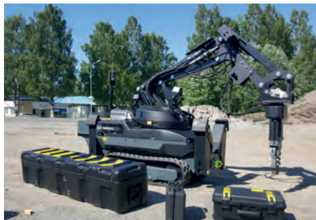
Il più piccolo dei robot della gamma Brokk. B60 dal peso di 500 kg largo appena 60 cm con una forza di sollevamento di oltre 100 kg, utilizza utensili idraulici da 70 kg
