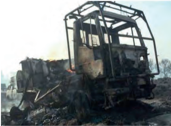
L'innesco dei pneumatici genera una fonte d'energia costante che favorisce la propagazione delle fiamme al resto degli elementi del veicolo
