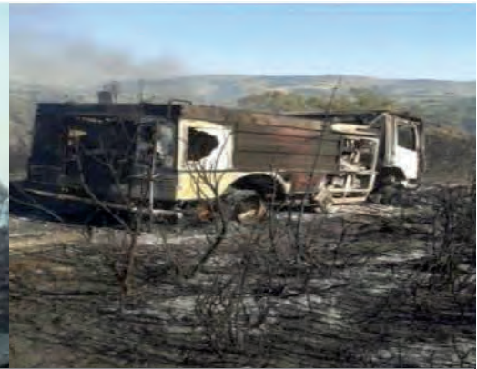
L'innesco dei pneumatici genera una fonte d'energia costante che favorisce la propagazione delle fiamme al resto degli elementi del veicolo
