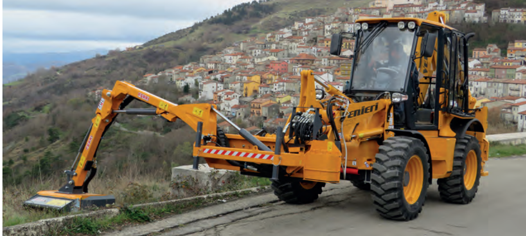
Terna Articolata multifunzionale equipaggiata con decespugliatore anteriore al lavoro nella Provincia di Chieti
