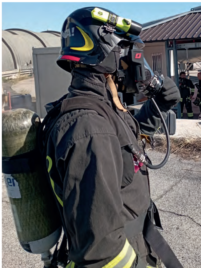
Scuola di Formazione Operativa dei Vigili del fuoco di Montelibretti (RM). I Vigili del fuoco testano il sistema 3M Scott composto da autorespiratore ProPak-f EZ-flo e maschera con termocamera integrata Sight Pro Package
