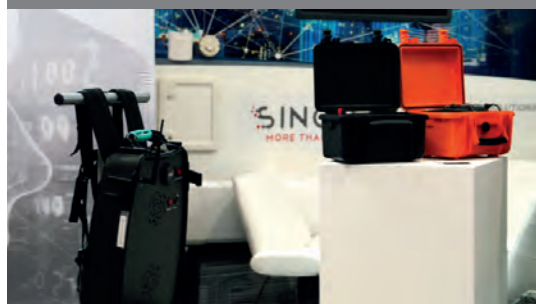
Ripetitore Spalleggiabile ST.RIT Backpack, zaino rigido a tenuta stagna, ermetico e indeformabile, che contiene una stazione ripetitrice completa di filtro duplexer
